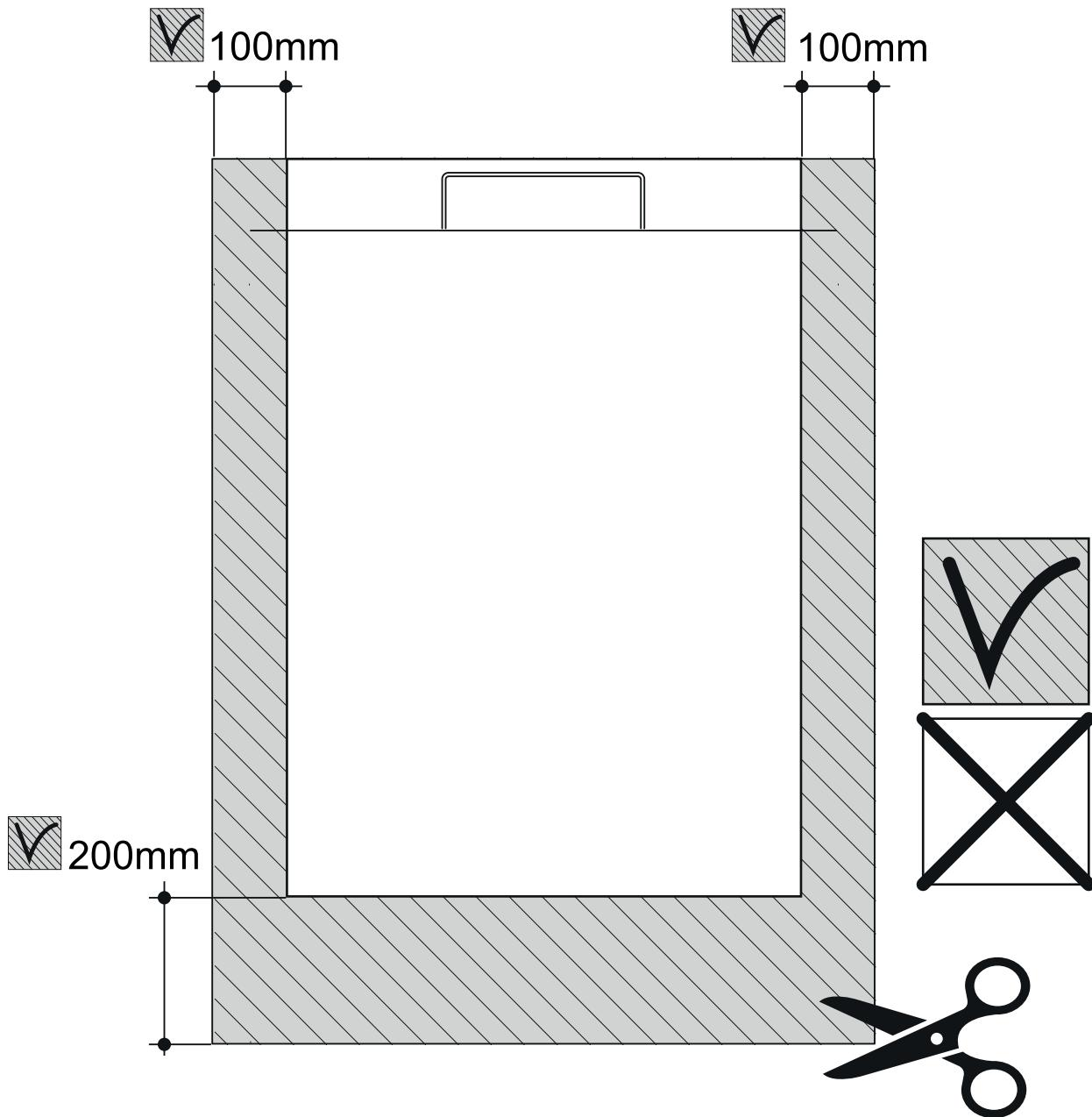
**FR :** Le receveur de douche est recoupable selon les zones de découpe indiquées ci-dessus. Pour cela, utiliser une scie à onglet, disque diamant, vitesse de rotation la plus élevée
