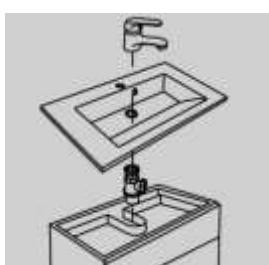
Le plan doit être compatible avec le meuble (installation des siphons et des bondes).
