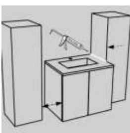
Zie erop toe dat er voldoende ruimte is tussen de kolom en het wastafelmeubel om te voorkomen dat er een ruimte ontstaat waar water kan blijven staan. Anders moet u beslist een afdichting tussen het wastafelmeubel en de kolom aanbrengen.
