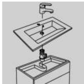
Het werkblad moet voor het meubel geschikt zijn (installatie van sifon en afvoer). In geen enkel geval mag het meubel verzaagd worden om het plaatsen te vergemakkelijken (plint, doorgang voor afvoer, sifon,...).
