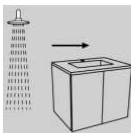
Om dezelfde reden, laat u een voldoende grote ruimte tussen uw meubels en uw watertappunten (douche, badkuip, bidet, ...) of laat een waterdichte wand installeren om spatwater of ophoping van water te voorkomen.
