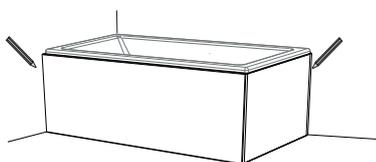
Possibilité de recouper le tablier, (par exemple pour laisser passer un tuyau), à l'aide d'une scie à main ou une scie sauteuse avec une lame à denture fine.
