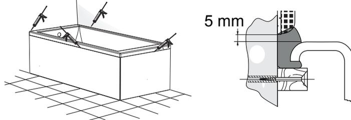
4) -Rehausser le tablier à l'aide des vis de réglage (M6x35) pour écraser légèrement le joint silicone, lisser ensuite et terminer par les côtés.
