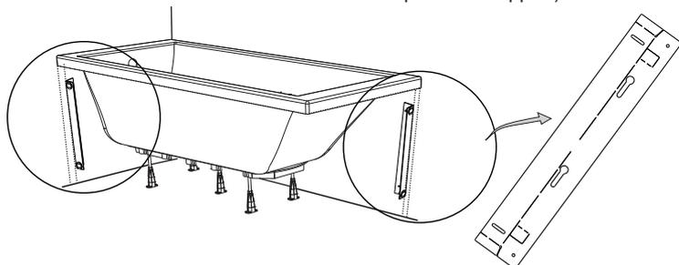
2) -Fixer l'adhésif (D) sur la platine (E), au préalable, nettoyer la surface de la platine avec un décapant (Alcool à brûler, Acétone....). Monter l'ensemble sur les aimants, puis enlever la protection de l'adhésif.
