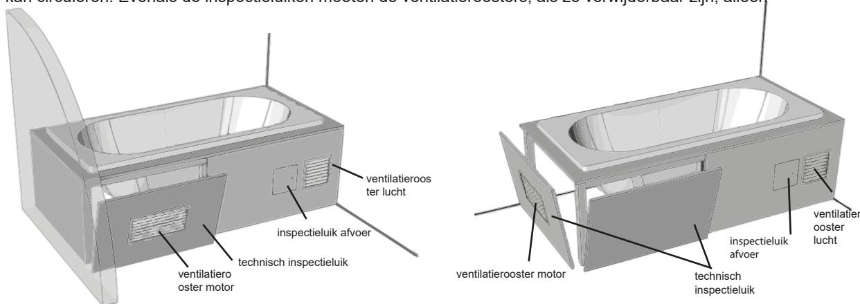
Met een mantel is het niet nodig een inspectieluik of een luchtrooster te voorzien (er is - mits juist geplaatst - voldoende lucht circulatie over de randen heen).
