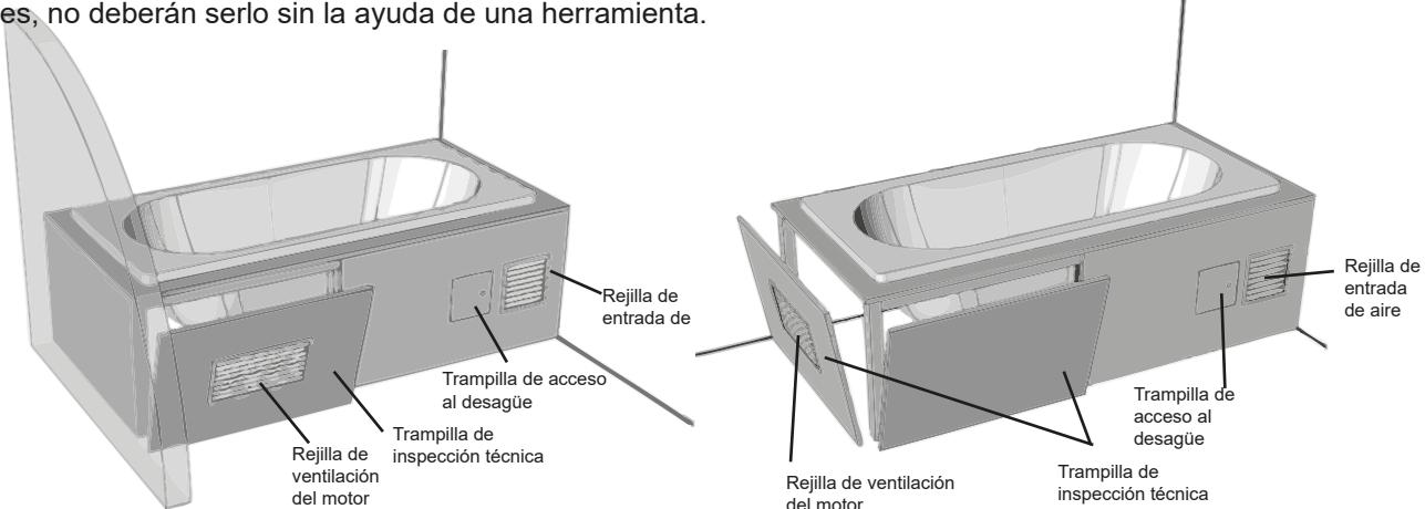
Con un faldón, no es necesario proveer trampillas de acceso ni rejillas de ventilación, siempre que el faldón se instale conforme a sus instrucciones de montaje, sea desmontable con la ayuda de una herramienta y permita el paso de aire sobre los bordes.
