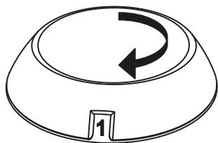
o Le bouton venturi permet d'intensifier le massage latéral procuré par les buses, en injectant de l'air (grâce à l'effet Venturi). L'intensité maximale est atteinte au bout d'un quart de tour.
