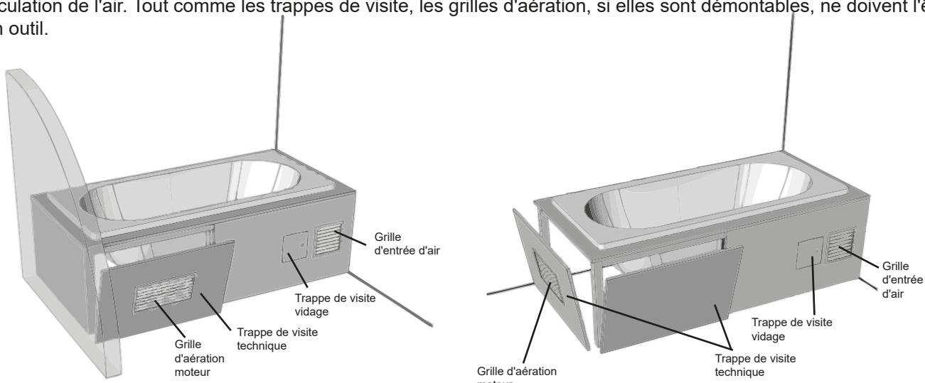
Avec un tablier, il n'est pas nécessaire de prévoir des trappes de visite ou des grilles d'aération, dès lors que le tablier est installé conformément à sa notice de montage, il est démontable à l'aide d'un outil et laisse passer l'air sur les bords.
