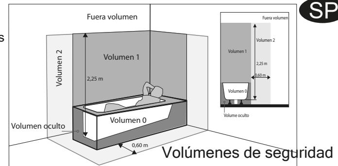
El cable de alimentación de la bañera de hidromasaje debe conectarse de forma permanente a la alimentación fija. La conexión eléctrica debe hacerse en una caja de empalmes de tipo IPX5 (no suministrada). Esta caja debe ser accesible (a través de una trampilla de inspección, por ejemplo) y deberá conectarse conforme a la norma UNE 20460-7.
